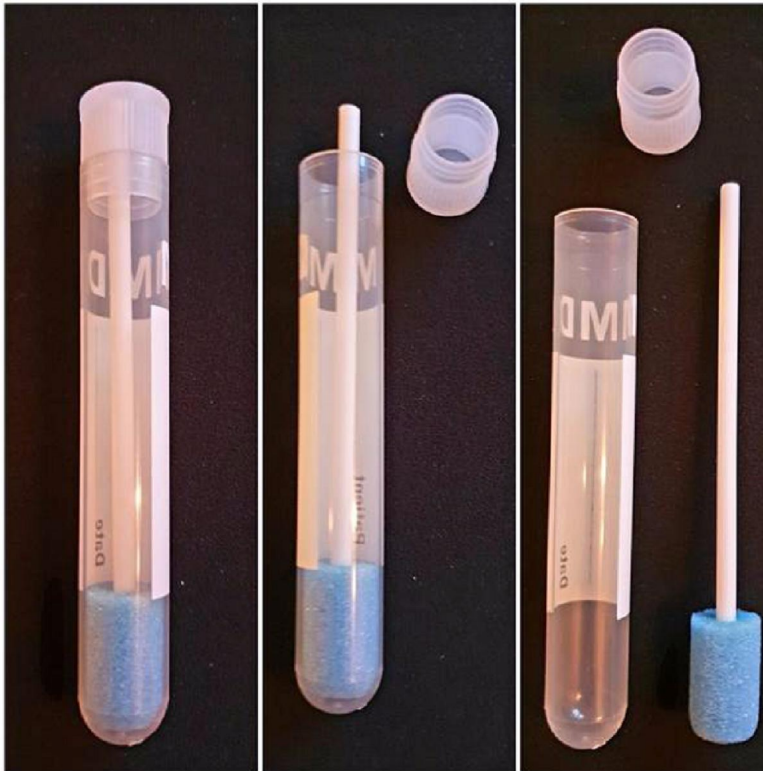
Figuur 2. Oracol S10 speeksel verzamel systeem. In de huidige opzet wordt alleen de spons gebruikt en uitgeperst in de Isohelix verzamelbuis. Verkrijgbaarheid speekselspons zonder buis wordt onderzocht.
